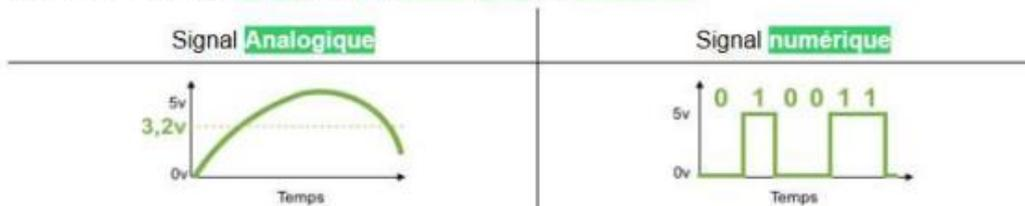
Ici en analogique, le signal transmit par le capteur est un niveau de tension qui évolue dans le temps entre 0 et 5V selon la grandeur mesurée. Exemple 3.2V à deux instants donnés.
